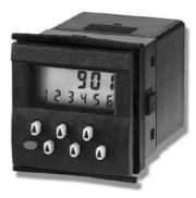
Der Typ VWZ 901 ist ein batteriebetriebener einfacher Impulsund Zeitvorwahlzähler mit Zähl- und Rückstelleingang für 12...250 V AC/DC oder mit NPN-Eingang.
